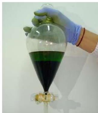
Gambar 1. Proses Purifikasi Metode LLE
